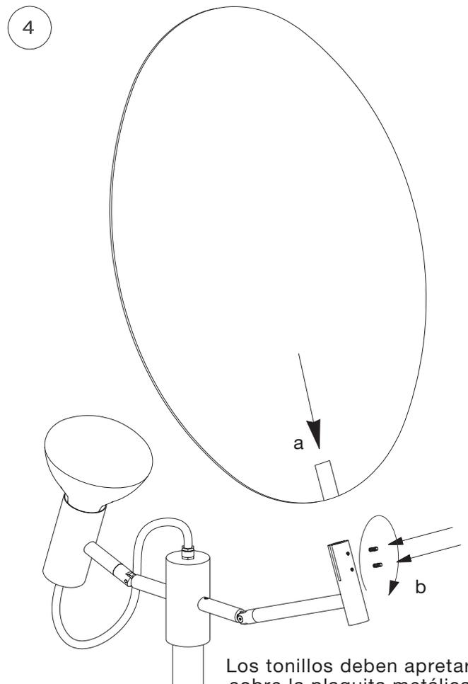
Los tornillos deben apretar sobre la plaqueta metálica.
