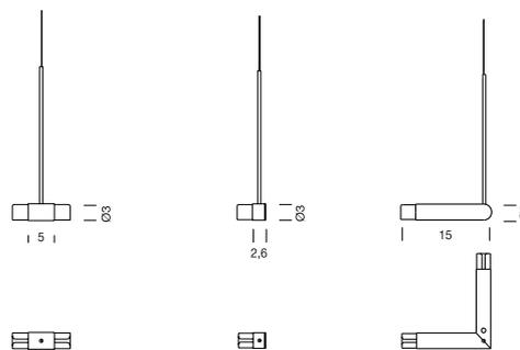
Conexión intermedia Conexión final Conexión en ángulo 90°
