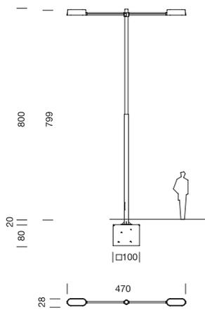
**Farola Candela de 8,20m de 2 secciones con 2 luminarias a la misma altura de brazo largo**
