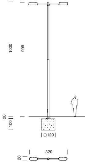
**Farola Candela de 10,20m de 2 secciones con 2 luminarias a la misma altura de brazo medio**
