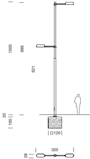
**Farola Candela de 10,20m de 2 secciones con 2 luminarias a distinta altura de brazo medio**
