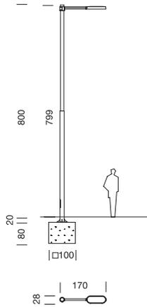
**Farola Candela LED de 8,20m de 2 secciones con 1 luminaria de brazo medio**
