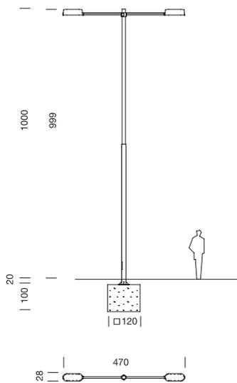
**Farola Candela de 10,20m de 2 secciones con 2 luminarias a la misma altura de brazo largo**
