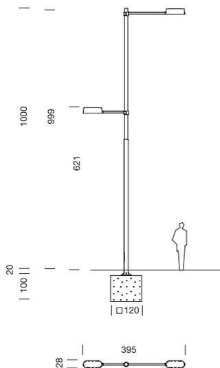
**Farola Candela de 10,20m de 2 secciones con 2 luminarias a distinta altura de brazo largo y brazo medio**
