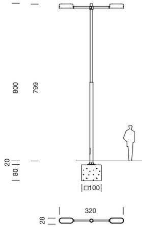
**Farola Candela de 8,20m de 2 secciones con 2 luminarias a la misma altura de brazo medio**
