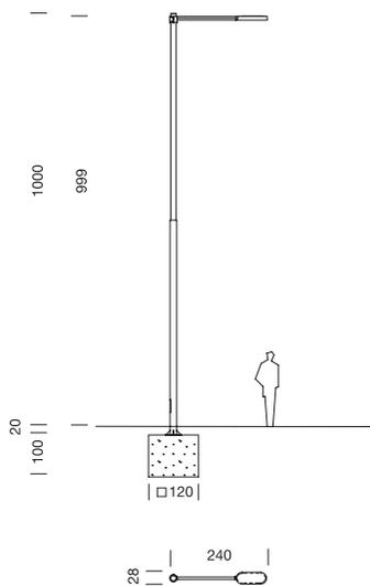
**Farola Candela LED de 10,20m de 2 secciones con 1 luminaria de brazo largo**
