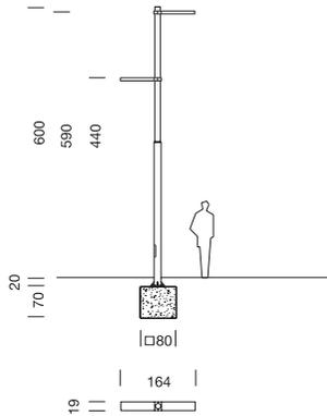
**Farola Rama LED de 6,20m de 2 secciones con 2 luminarias a distinta altura**
