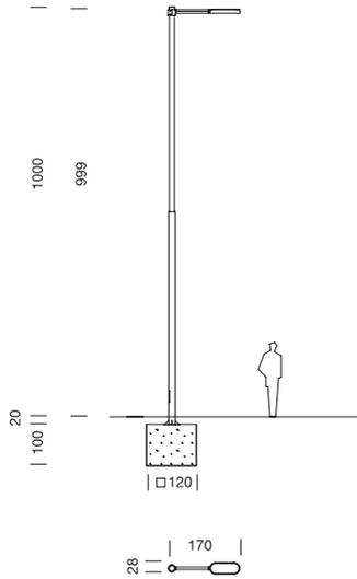
**Farola Candela LED de 10,20m de 2 secciones con 1 luminaria de brazo medio**
