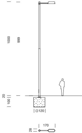
**Farola Candela de 10,20m de 2 secciones con 1 luminaria de brazo medio**
