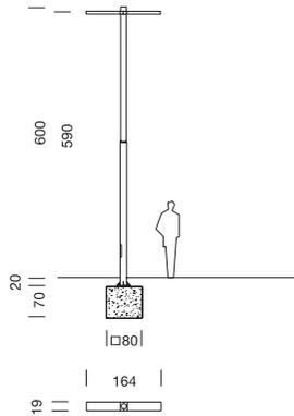
**Farola Rama LED de 6,20m de 2 secciones con 2 luminarias a misma altura**
