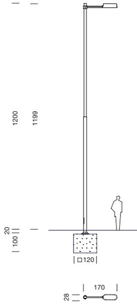
**Farola Candela de 12,20m de 2 secciones con 1 luminaria de brazo medio**
