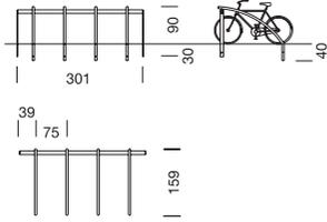
**Aparcamiento de bicicletas Bicilínea de un tramo. Empotrable**
