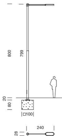
**Farola Candela LED de 8,20m de 2 secciones con 1 luminaria de brazo largo**
