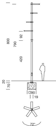
**Farola Rama LED de 8,20m de 2 secciones 5 luminarias a distinta altura**
