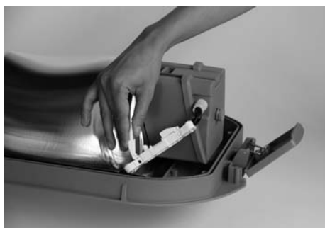
4 Liberación del seguro del conector
